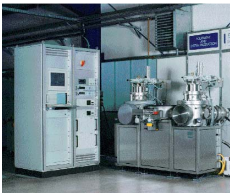
Mehrkammer-ECR-RIE-System für Fluor- und Chlorprozesse mit automatischem Proben-transfersystem (Foto: Roth & Rau AG Wüstenbrand)
