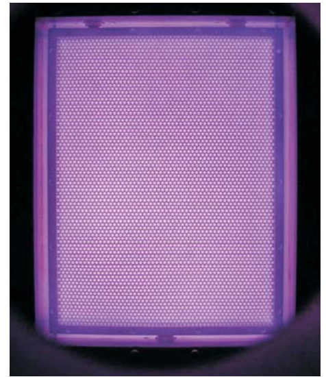
Abb. 3: MHC-Plasmaquelle in Betrieb (aktive Fläche: 150 \cdot 200 \text{ mm}^2 , Leistung: 1000 W, Prozeßdruck: 0,2 mbar) (Bild: Fraunhofer IST Braunschweig)
