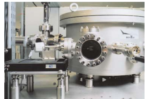
Abb. 3: Präzisionsantrieb für die Gitterbewegung zur Wellenlängeneinstellung am Monochromatorausgang (Bild: Fraunhofer IWS Dresden)
